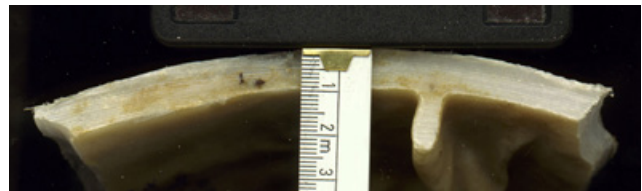
Abb. 5 – harzgefüllte Falte; SF-Liner
