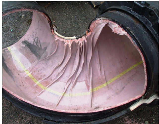
Abb. 4 – Falten im Bogenbereich eines Druckliners (werkseitiger Test)
