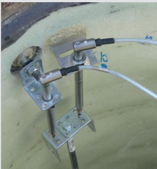
**Bild 1:** Um die Verschiebungen zwischen dem Liner und dem Altschacht messtechnisch zu erfassen, wurde im Schachtkopf der Liner durchbohrt und ein Messpunkt auf dem Beton angebracht
