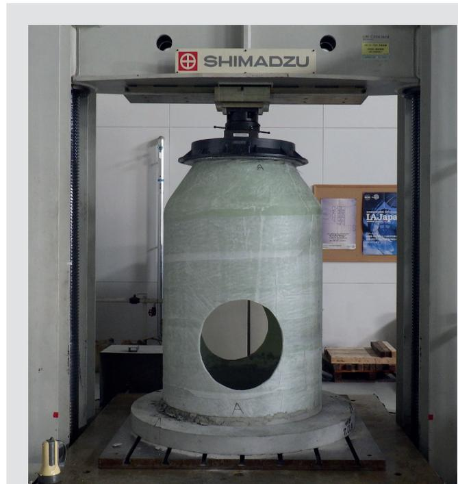
**Bild 2:** Vertikale Lastprüfung (Japan)
